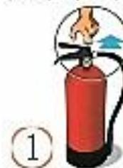
FIG. 2. Presionar la maneta.
